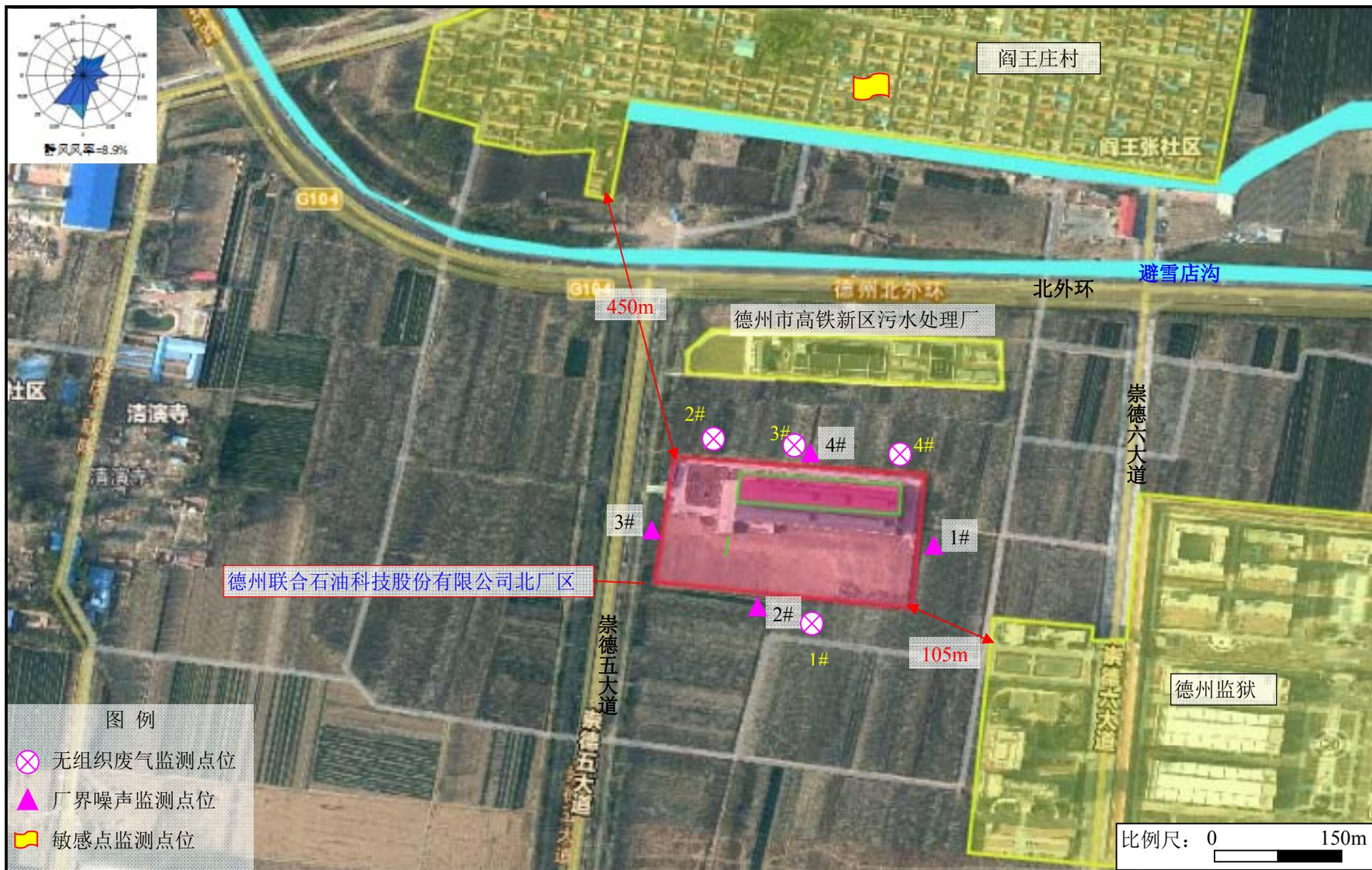
图 9-1 该项目无组织废气、厂界噪声、敏感点监测布点图
